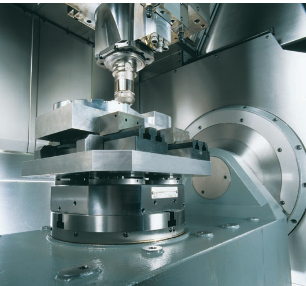
Tavola girevole/orientabile di precisione con massime prestazioni grazie alle soluzioni applicative dei marchi INA e FAG
