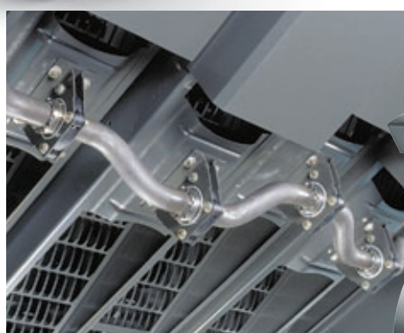
Rigidezza e compattezza: cuscinetto a quattro contatti INA in un albero per vaglio vibrante per mietitrebbia
