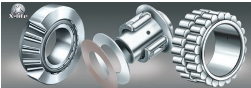
Ampia varietà di cuscinetti per riduttori: cuscinetti a rulli conici di qualità premium X-life, ad es. per il portasatellite dell'assale motore con capacità estreme di assorbimento delle forze centrifughe – cuscinetto radiale a rulli cilindrici a due corone senza anello esterno per riduttori epicicloidali
