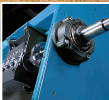
Di nuova concezione: unità di supporto e cuscinetto con bussole di trazione incorporate, resistente allo sporco, per regimi elevati e forti carichi d'urto
