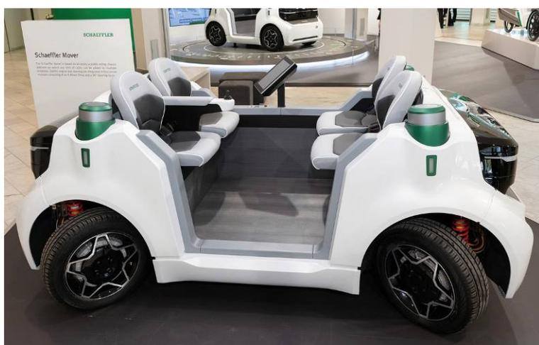
Caption: lo Schaeffler Mover è un concept per un rolling chassis piccolo ed altamente versatile che è interamente elettrico e può essere composto con varie versioni di carrozzeria per supportare una vasta gamma di applicazioni differenti per la mobilità urbana ed i trasporti.
