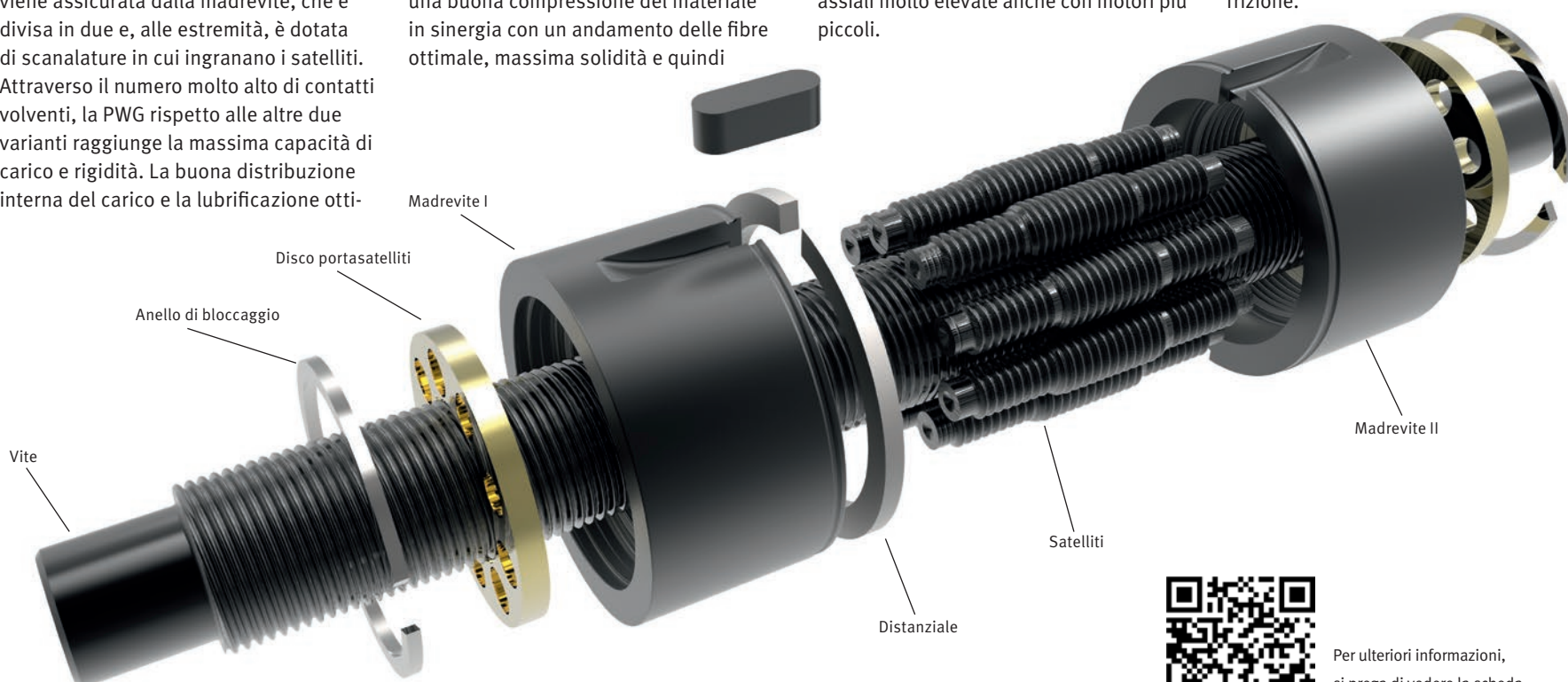
Struttura della vite a rulli satelliti PWG: vite e satelliti sono prodotti senza asportazione di truciolo.
