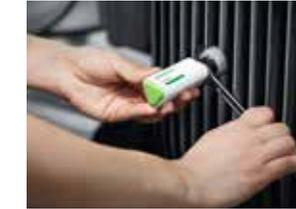
I sensori di analisi vibrazionale vengono collegati a ciascuna macchina utilizzando un foro filettato oppure una basetta incollata sul punto applicativo. Quindi vengono attivati tramite NFC (Near Field Communication). Tutti i sensori si connettono automaticamente tra loro ed al gateway, formando una rete mesh indipendente, che, tra le reti IoT disponibili oggi, è una tra le più affidabili ed energeticamente efficienti. Il sistema può essere ampliato con ulteriori sensori in qualsiasi momento.
