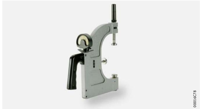
Per la misurazione di coni esterni con angolo conico da 0° fino a 6° e diametro del cono da 90 mm fino a 510 mm si raccomanda l'utilizzo dello strumento di misura della conicità MGK 132.
