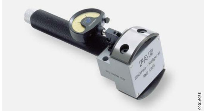
Lo strumento MGA 31 viene utilizzato per la regolazione del gioco radiale di cuscinetti a rulli cilindrici con foro conico e anello esterno estraibile. E' adatto per cuscinetti a rulli cilindrici da NN3006-K fino a NN3048-K e da N1006-K fino a N1048-K. Lo strumento di misura consente di impostare con esattezza il gioco radiale o il precarico dei cuscinetti a rulli cilindrici.
